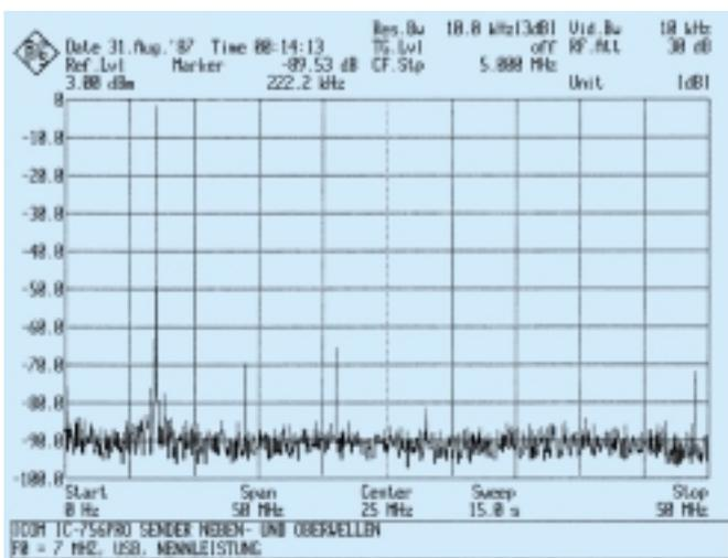
Bild S3: Sender-Neben- und Oberwellen (KW)
