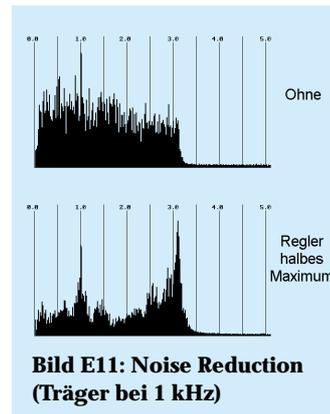
Bild E11: Noise Reduction (Träger bei 1 kHz)
